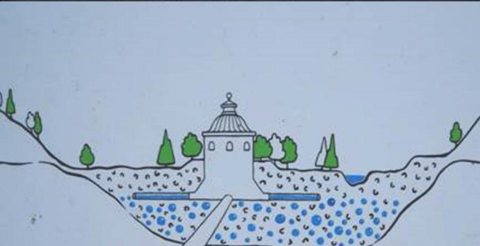
Les captages se font entre 50 et 70 m de profondeur, l'eau issue des 6 sources de la Mangfalltal convergent vers un château d'eau, puis vers Munich par des canalisations souterraines (débit de 1500 l/s )
