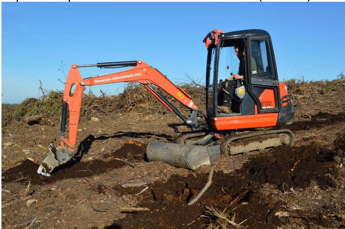
*Photo N1791: Réalisation d'un potet (Auteur C.VIDAL CNPF-IDF)*
