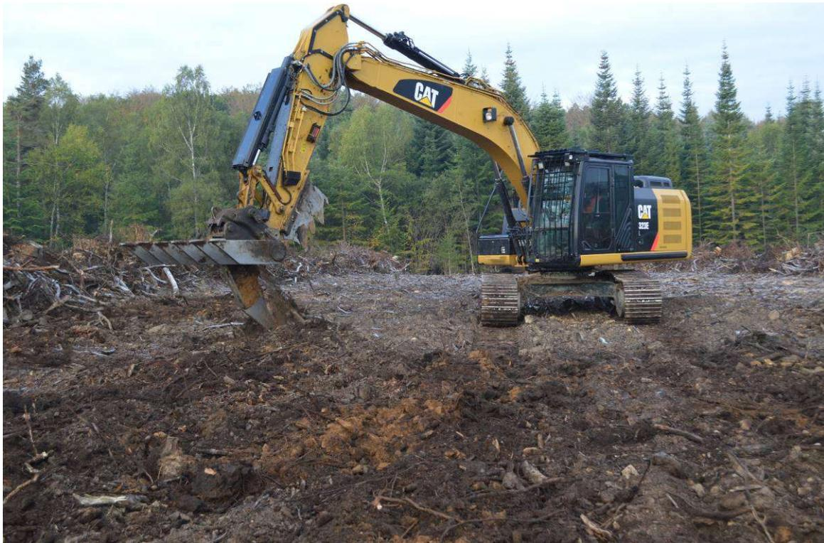
*Photo N1617: Sous-solage avec la dent Bertrandie (Auteur C.VIDAL CNPF-IDF)*
